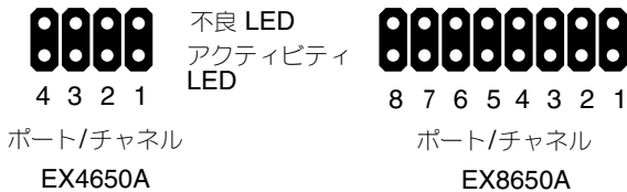
図 7. グローバルおよび集約された LED ピン、EX4650 および EX8650
